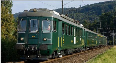
Nel prossimo futuro verranno dismessi treni pendolari dove sono impiegate le RBe540. Verranno rimpiazzati con treni pendolari di nuova generazione che corrispondono alle moderne esigenze dei passeggeri. Sono state costruite ca. 80 motrici di questo tipo e la loro velocità massima è di 125 km/h.
