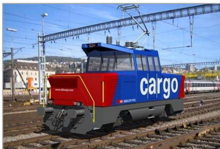
La Eem 923 che a partire dal 2012 verrà consegnata a FFS Cargo dispone, accanto al doppio motore elettrico, di un motore diesel aggiuntivo per l'utilizzo sui binari sprovvisti di linea di contatto. Con una velocità massima di 120 km/h questa nuova locomotiva di manovra è anche in grado di percorrere la rete ferroviaria svizzera.
