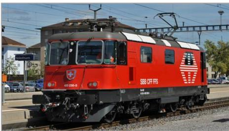
A causa dei vari programmi di ristrutturazione, di ammodernamento della flotta con locomotive pluricorrente nel traffico internazionale e della ridotta domanda di trasporti per via della crisi economica, sono ferme diverse locomotive Re420, la loro velocità massima è di 140 km/h.
