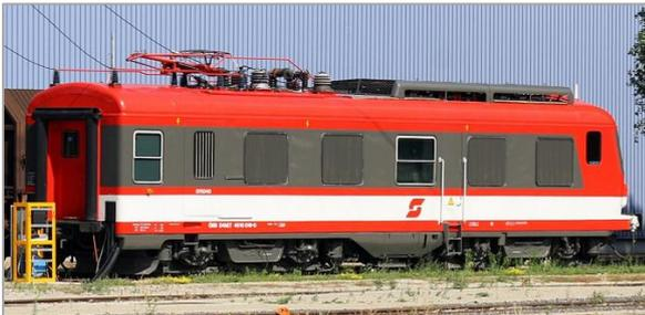
Di questo "Alpenexpress" sono state dismesse 9 locomotive. Hanno un reparto bagaglio che si potrebbe trasformare in un vano dove installare il motore diesel per raggiungere le proprietà richieste di treni merci pendolari ibridi. Raggiunge una velocità massima di 150 km/h.
