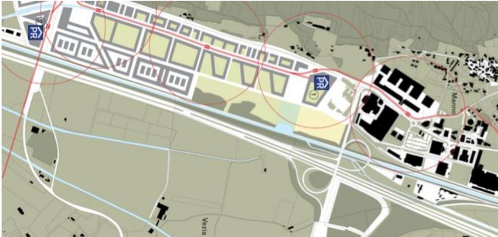
**Abbildung 1:** Trasseeführung des Trams hinter der ersten Gebäudereihe
